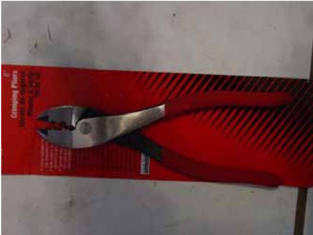
Figure 5 – Crimping Pliers
